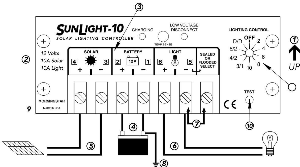
6. Connecter l'**ECLAIRAGE** en dernier. Si la DEL rouge s'allume, la charge de la batterie est basse. Recharger la batterie avant d'installer le système (voir l'article 6.4).
