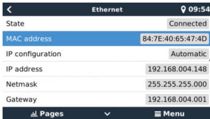
Si vous utilisez Ethernet et que l'état indique « Débranché », vérifiez que le câble de réseau Ethernet n'est pas défectueux en essayant de brancher un autre câble. Les deux voyants à l'arrière du Cerbo GX, au niveau du branchement du câble Ethernet RJ45, doivent être allumés ou clignoter. Deux voyants éteints indiquent un problème de connexion.
