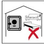
Pendant certaines phases de fonctionnement, l'onduleur peut produire un léger bruit. Par conséquent, il ne doit pas être installé dans des espaces de vie.
