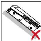
L'onduleur ne doit pas être monté sur une surface inclinée avec les connecteurs vers le haut.
